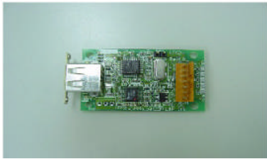
LF62-3-0-2-0 ・通信部コネクタ:IL-G7P(RS-232C) ・電源コネクタ:無し ・USB部コネクタ:標準A(フランジ有り)
