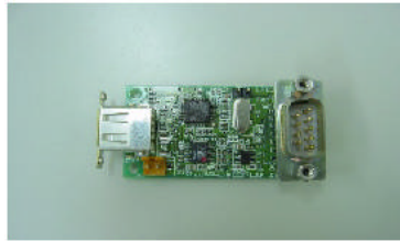
LF62-7-1-2-0 ・通信部コネクタ:D-SUB9P(オス)縦 ・電源コネクタ:有り ・USB部コネクタ:標準A(フランジ有り)
