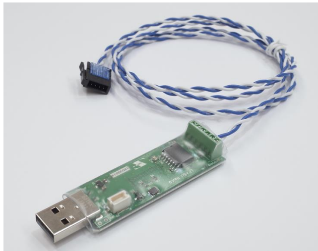
付図 1. USB-CAN 変換ボード (LFA6U)
